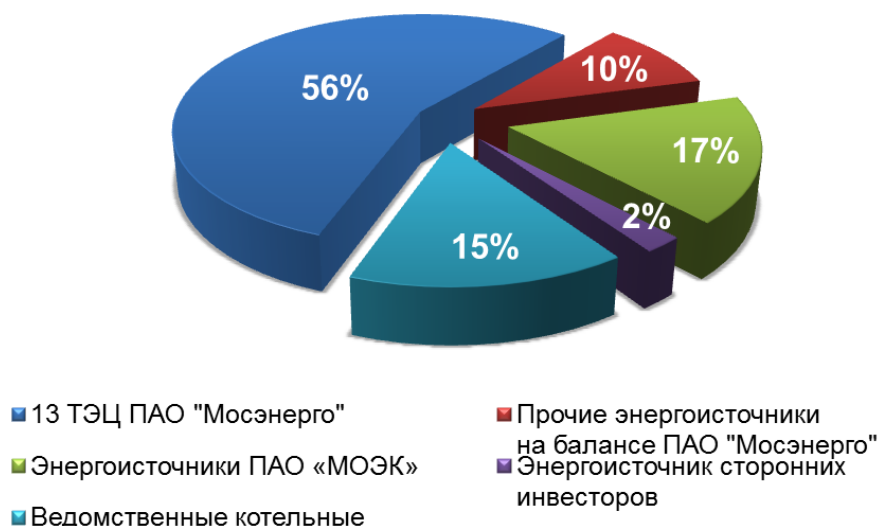
Рисунок 2.1 – Структура обеспечения тепловых нагрузок потребителей в системе централизованного теплоснабжения города Москвы по состоянию на 01.01.2015
